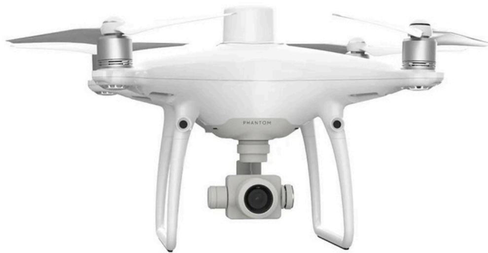
O DJI Phantom 4 RTK possui um sensor de CMOS de 1.2 polegada e 20 megapixels e alcança uma distância de amostra do solo(GSD) de 2,74 cm a 100 metros de altitude de voo. O obturador mecânico tem menos esforço na obtenção imagens durante o mapeamento o que permite a captação de mais imagens e menores riscos de distorção. Cada uma das lentes do DJI Phantom 4 RTK passa por um rigoroso processo de calibração para a medição de distorções radiais e tangenciais.
